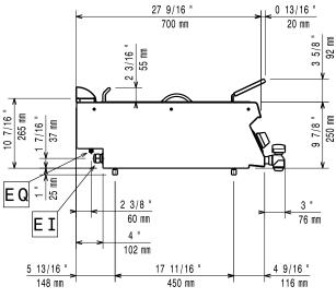
El = Electrical inlet (power) EQ = Equipotential screw
